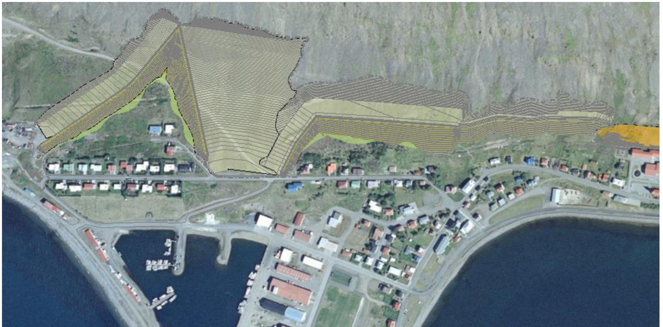
Mynd 2-2. Yfirlitsmynd sýnir niðurstöðu frumathugunar sem gerir ráð fyrir að byggðir verði tveir snjóflóðavarnargarðar ásamt lágum aurvarnargarði.
